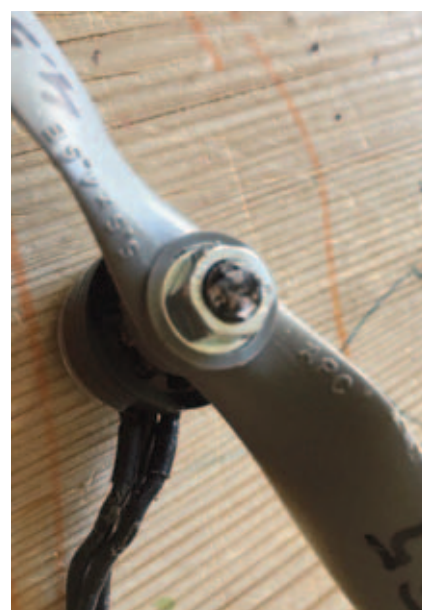
Motorakslen blev slået flad i spidsen, så propellen ikke kan tages af. Lejet i motoren er også ødelagt.
