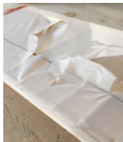
Vingen tog så meget skade af mødet med betonbanen, at det ikke kan betale sig at reparere den. Det vil være hurtigere at bygge en ny.
