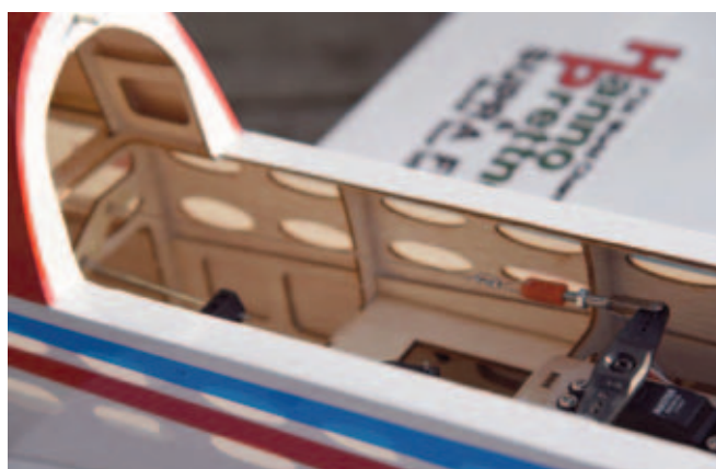
Hele modellen er fuld af letningshuller for at holde vægten så lav som muligt.
