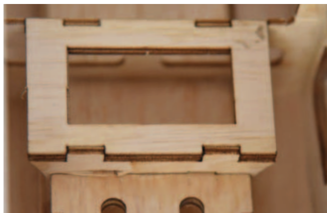
Motorservomontering skal fjernes for at få tyngdepunktet på 165 mm fra for-kanten på eludgaven.
