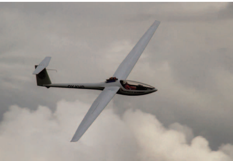
Keld Hansens DG-303 svævefly .. med jetmotor til starthjælp..
