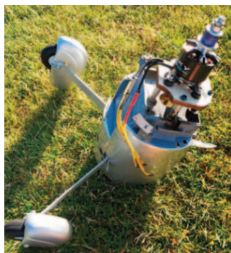
Motorfundament m.m. brækket af kroppen
