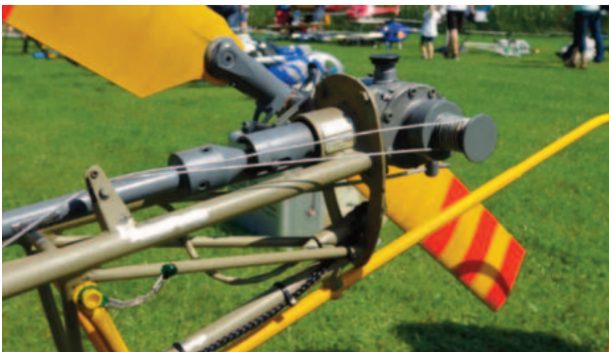
Typisk Alouette II wirestyret halerotor
