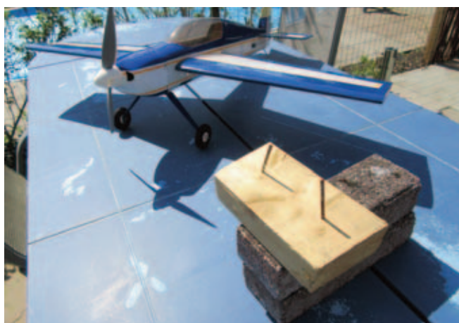
Simpel jig til tyngdepunkts tjek. Det er 2 søm hvor hovedet er klippet af. (Det kan helt sikkert laves pænere, men det virker)
