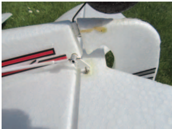
Limen havde næsten sluppet så højderor kun gav udslag opad men næsten ikke nedad. Model kom sikkert ned på jorden. Nu er det sikret med en skrue og lim.
