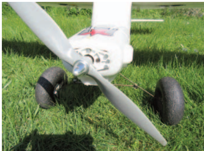
To løse skruer gav "flutter" under flyvning ved visse motoromdrejninger
