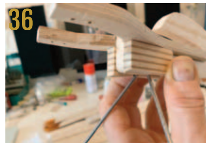
36 Stellet limet fast ved hjælp af motorfundament i finer samt klodser lavet af sammenlimet abachi og mahogni - frækt.
