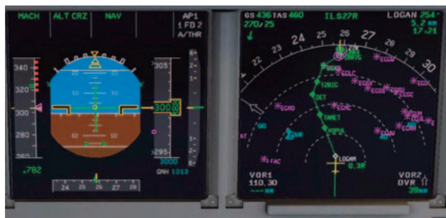
Til venstre ses Flight Displayet. Til højre ses Navigations Displayet. Dette viser STAR BIG1E, der er en af de standardiserede indflyvningsruter, som fører ind til hvor Instrument Landings Systemet (ILS) kan overtage landingen på Heathrow bane 27R.
