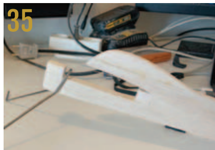
35 Kroppen skåret ud i 10mm balsa og stellet i 2.5mm piano klar til fastlimning
