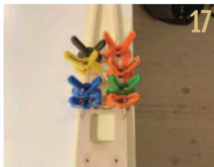
Kroppen opbygges af krydsfiner motorfundament, med fyrrelister i halen.
