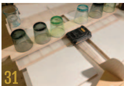
31 Ballast imellem lakering for at undgå skævriddninger og sideroret er limet på efter japanpapir
