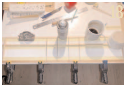
Grundsetupet i vingen er de tre fyrrelister for-kant, hovedbjælke og bagkantliste.
