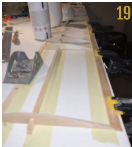
Krydsfinersspanterne limes på plads.
