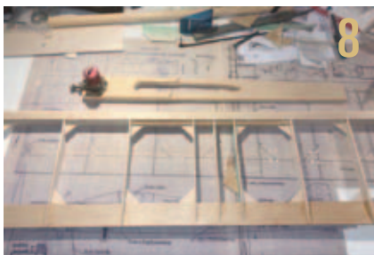
Vingen og kroppen bygget færdig med div forstærkninger. Kroppen har ud over motorens bøgelister og krydsfinerssider også en fyrreliste gående i hele kroppens længde
