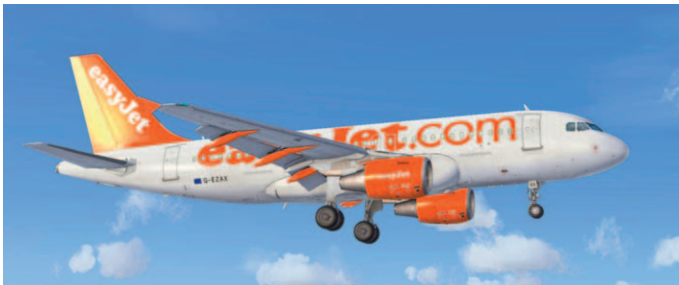
EasyJet A319 konfigureret til ILS landing, med Full Flaps, Gear Down, Auto Spoilers og Auto Brakes.
