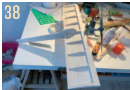
38 Vingen tilpasset kroppen, den skal først limes efter beklædning
