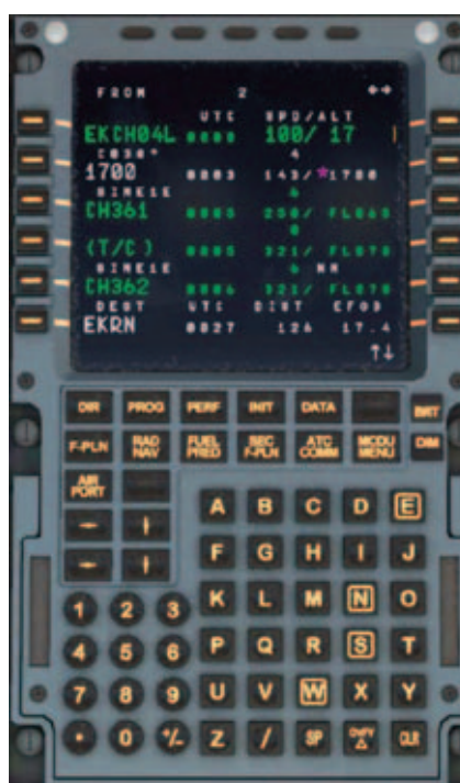
Billedet viser MCDU'en hvorfra programmeringen af Airbussen finder sted. Klar til landing i London.
