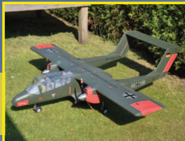
Pilot: Leif Poulsen Model: North American Rockwell OV-10A Bronco med el-setup 2 x 5S LIPO og 180cm spændvidde Foto: Peter Weichel
