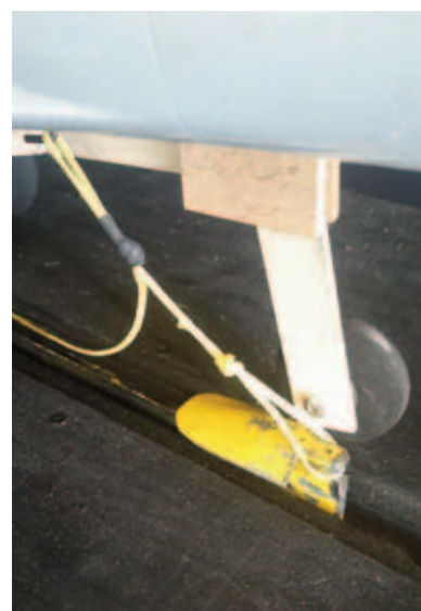
Kraftoverførsel fra skinne til model med træksnor
