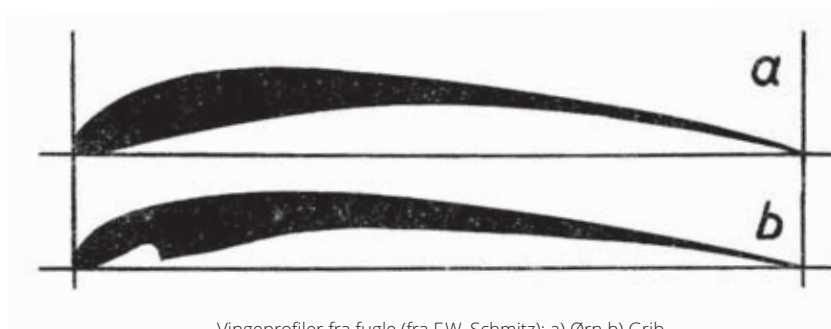
Vingeprofiler fra fugle (fra F.W. Schmitz): a) Ørn b) Grib
