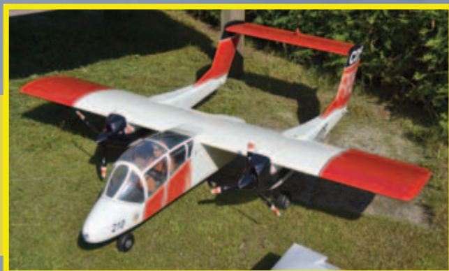
Pilot: Jan Rundstrøm Model: North American Rockwell OV-10A Bronco med el-setup 2 x 5S LIPO og 180cm spænd- vidde Foto: Peter Weichel
