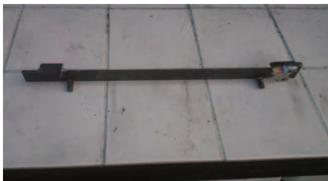
Skinne - lavet af metal og svejset, sikrer en ensartet kraftoverførsel til flyet når snoren skydes af plant med dækket
