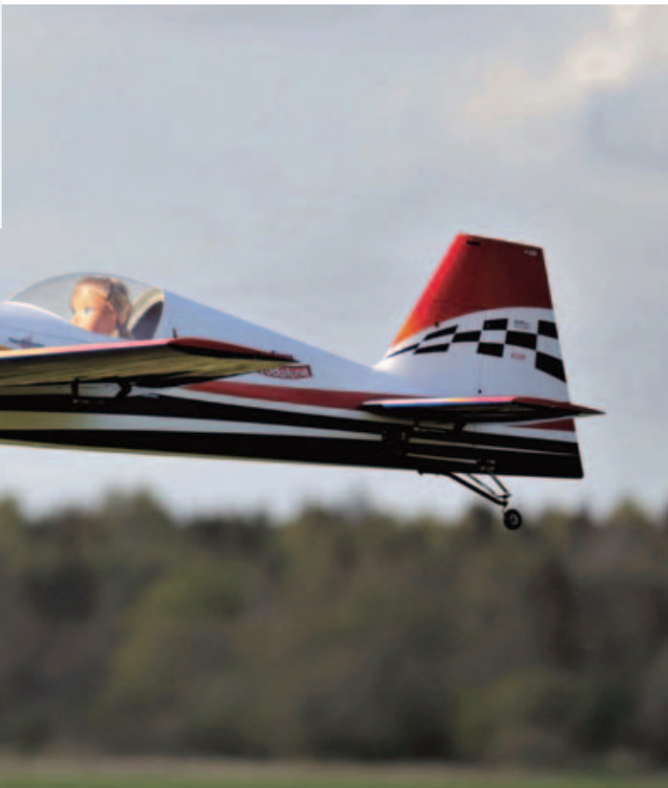
Extra 330 Pilot: Kurt Hevang. Radio: Futaba T18SZ Klub: Bjerringbro/Pandrup. Sted: Viborg MFK. Spændvidde: 231cm. Længde: 210 cm. Vægt: 11 kg. Motor: DA 60ccm. Modtagerbatteri: 3000 mAh Proppe: 24" x 10".
