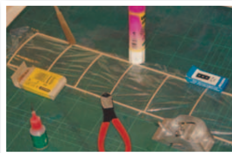
På grund af limen vil delene have en tendens til at bøje lidt. Derfor lægges et par "vægte" på, til limen er tør.
