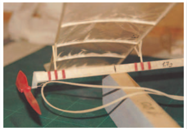
Tre positioner for papirrørene blev afprøvet. De overflødige kan eventuelt skæres bort. Stregen viser tyngdepunktet.
