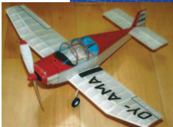
En Peanutmodel af en Jodel 112. Man kan se gummimotoren i cockpittet.
