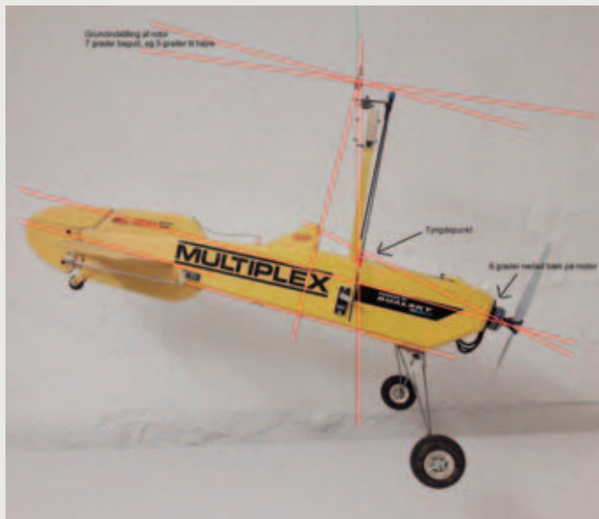
Tracktorgyroen hænger og viser "hang angle" på 15 gr.
