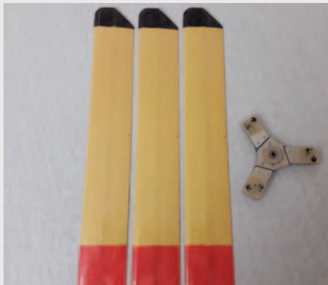
De færdige blade som er maalede, og derefter belagt med klar tape.
