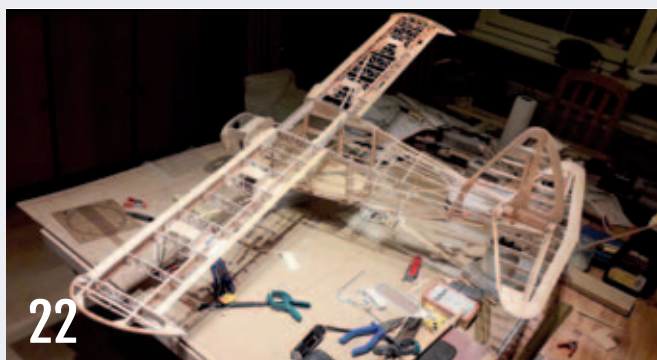
Så kan der laves en prøvemontering efter påsætning af haleplan og højde- og sideror. I første omgang uden at krængorer og slots er monteret (22).
