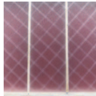
Nærbillede af en beklædningsprøve med Icarex. Man kan tydeligt se strukturen i beklædningsfolien.
