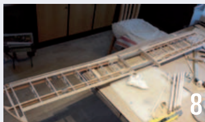
Tipperne laves som laminerede buer, og den halve vinge holdes fastspændt i den rigtige form for at sikre en smule washout og for at forreste bjælke sidder korrekt i forhold til hovedbjælkens H-konstruktion (6 og 7). Det kan være praktisk at kunne afmontere vingerne under transport, derfor laves en midtersektion med to firkantede rør af aluminiumsplade som stængerne, der går ud i vingerne, kan gå ind i. Samtidig sørger denne sektion for V-formen (8).
