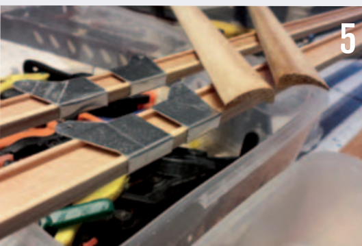
Krængerorene skal først monteres sent i bygningen af vingerne, som starter med hovedbjælken (5). På dette foto ses også de to beslag til stræberne og de smukke slot-forkanter.
