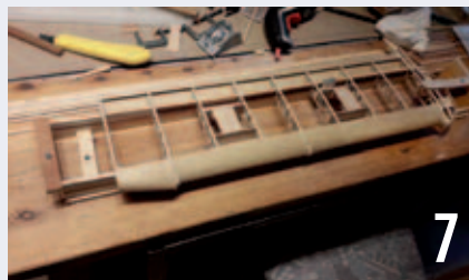
Når gitteret er færdigt, kan de to pladestykker monteres (2).
