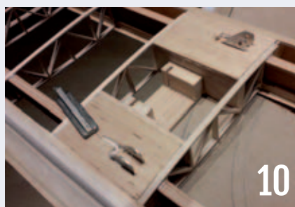
Beslagene til stræberne og holderen til krængerorsservoen blev lavet i en slags modul, der kunne sættes i på én gang (10).
