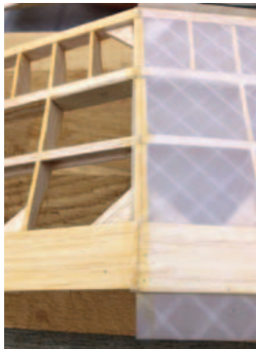
Ribben i V-forms-knækket skal have ekstra lim, når centralplanet er beklædt for at Icarex'en på øret kan hæftes fast.
