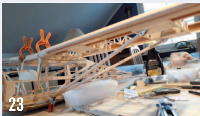
Så kan der laves en prøvemontering efter påsætning af haleplan og højde- og sideror. I første omgang uden at krængorer og slots er monteret (22).
