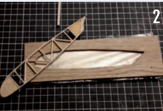
Når gitteret er færdigt, kan de to pladestykker monteres (2).
