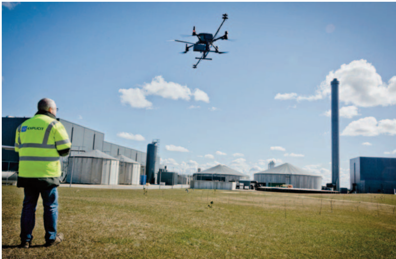
På det seneste har flyveteamet fra Explicit kastet sig over at måle klimagasudledninger, her fra et biogasanlæg i Midtjylland. Dronen er en DJI Matrice 300 med en særlig payload udstyret med en metanmåler og to specialudviklede 'vindsensorarme', der måler den faktiske vind under flyvningen.
