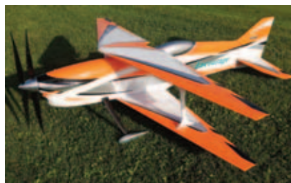
BJ Craft Encourage model fløjet af Finn Mortensen i RC parken 2021. Bemærk de kontraroterende propeller.
