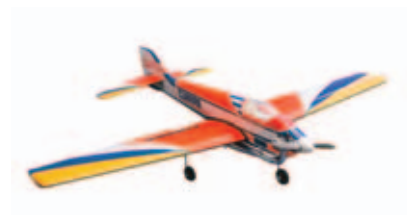
Hanno Prettners Curare. Modellen er startskudt på en aera hvor modellerne bliver mere avancerede. Modellen har optrækkelig understel og bremseflaps. Modellen kan i dag købes som ARF model - både til brændstof og til el Kilde: www.modster.at
