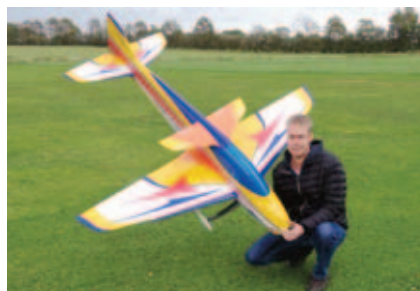
Krill Spark Evo2 med sin ejer. Modellen er designet i tiden hvor elmotor var blevet dominerende. Typisk er F3A elmotorer "front mounted" - og det er dermed ikke helt let at montere en forbrændingsmotor i sådan en model når der ikke er et motorskot.
