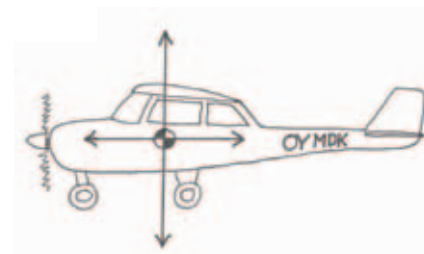
FIGUR 9 Kræfterne på et motorfly, der flyver lige fremad i konstant højde.
