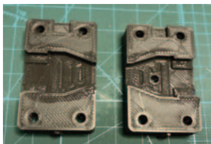
3D printet støbeform med vokbaseret slipmiddel i. Men succesen var noget begrænset.
