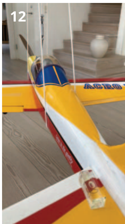
12 Modellen er faldet til ro og CG kan aflæses. Du kan bruge Vanessa Rig'en til alle vingetyper, så længe du kan få linerne neden om næsen og halen. Faktisk kan man også lade linerne løbe neden om hver af vingerne. Det fungerer også fint.
