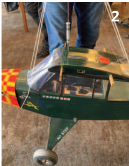
Loddet hænger fint og peger på tyngdepunktet.
