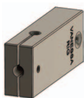
12 Modellen er faldet til ro og CG kan aflæses. Du kan bruge Vanessa Rig'en til alle vingetyper, så længe du kan få linerne neden om næsen og halen. Faktisk kan man også lade linerne løbe neden om hver af vingerne. Det fungerer også fint.
