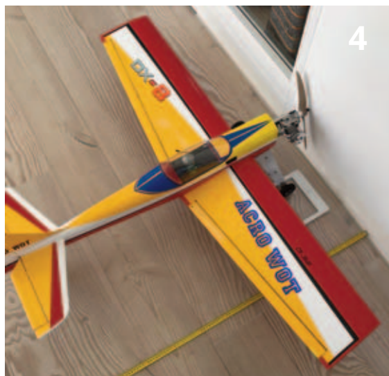
Denne lille Chris Foss Acro Wot er skubbet op til væggen som gør det ud for "DATUM" i den her lille vejning.
