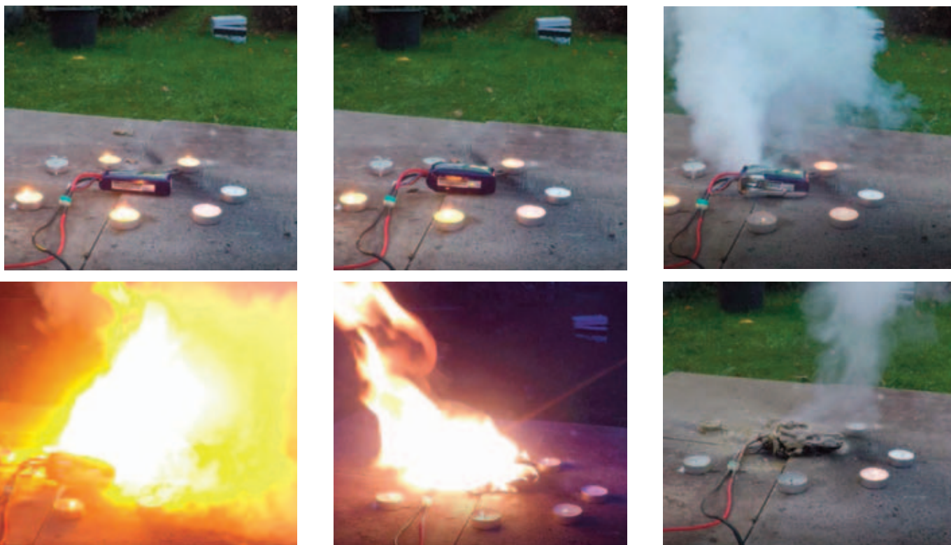
TEST 2: 3S 2200 slipper brintgas ud og så snart en antændingsklide er i nærheden bryder branden ud. Litium slukkeren slukker let branden.
