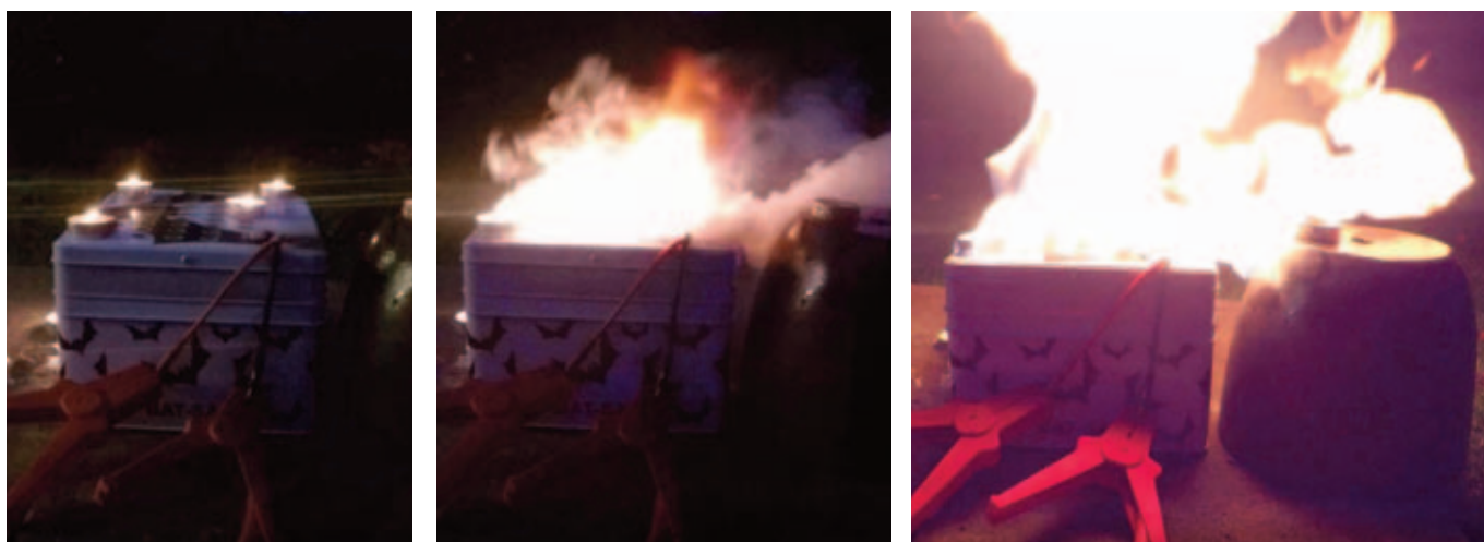
5S 4600 LiPo bryder i brand og gasserne antændes og en meter høj flamme kommer op af Bat Safe Boxen.
