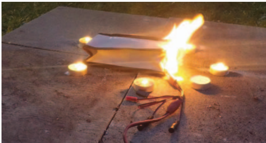
Sikkerhedsposen holder ikke flammerne inde. De gasser der kommer ud antændes hvis der findes varmekilde i den umiddelbare nærhed. Fx glødende fartregulator. Her har vi sat lidt fyrfadslys op og det illudere varmekilder. Batteriet bryder i brand og posen holder størstedelen af flammerne inde, men det modvirker ikke en større brand i hobbyrummet eller i bilens bagagerum.
