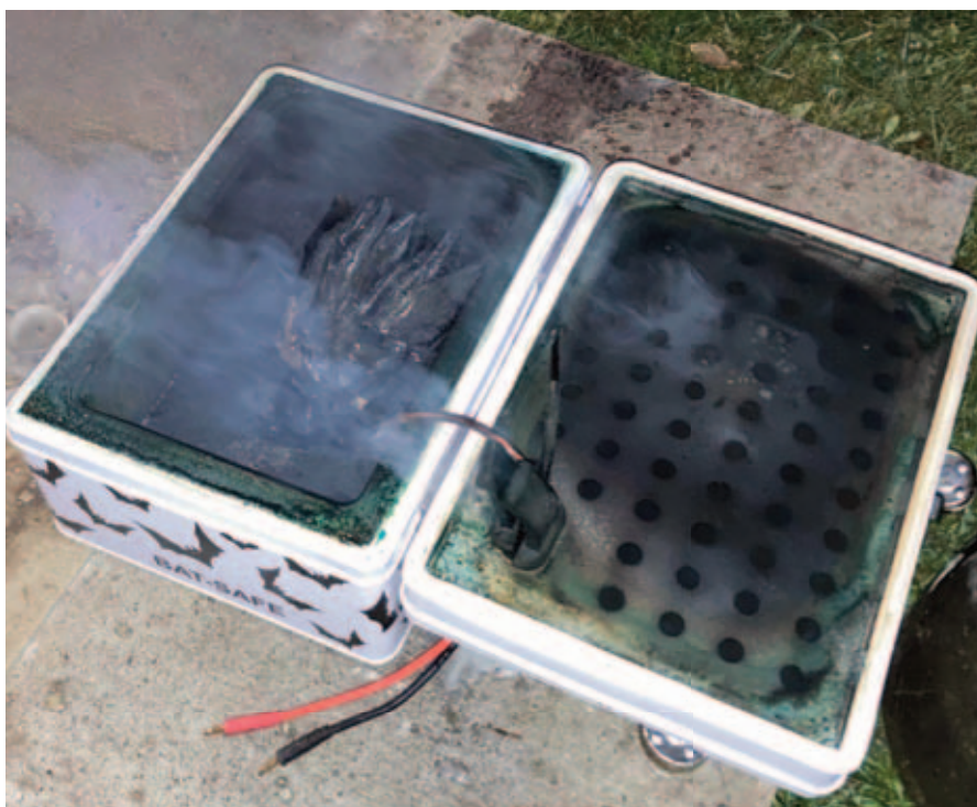
Bat Safe box holder batteriet inde og begrænser skaderne, men den bliver svær at genbruge efter en brand.
