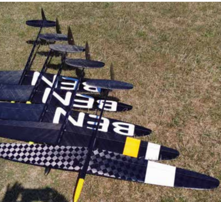
TV: Benjamins 5 fly, 3 Vortex 4, 1 Vortex 3 og en Flitz2. TH: Benjamin og Ole venter på at få tjekket flyene. De skal tjekkes for om de overholder reglerne. Max spændvidde 1500mm, og næsen må ikke være spids, så den måles på en særlig måde. Vores fly havde en spændvidde på 1497mm og næsen passede præcist.
