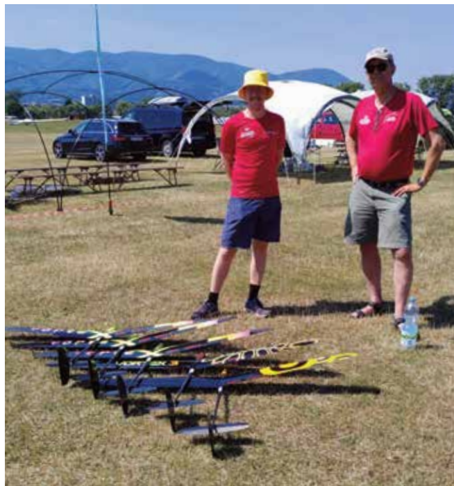
TV: Benjamins 5 fly, 3 Vortex 4, 1 Vortex 3 og en Flitz2. TH: Benjamin og Ole venter på at få tjekket flyene. De skal tjekkes for om de overholder reglerne. Max spændvidde 1500mm, og næsen må ikke være spids, så den måles på en særlig måde. Vores fly havde en spændvidde på 1497mm og næsen passede præcist.
