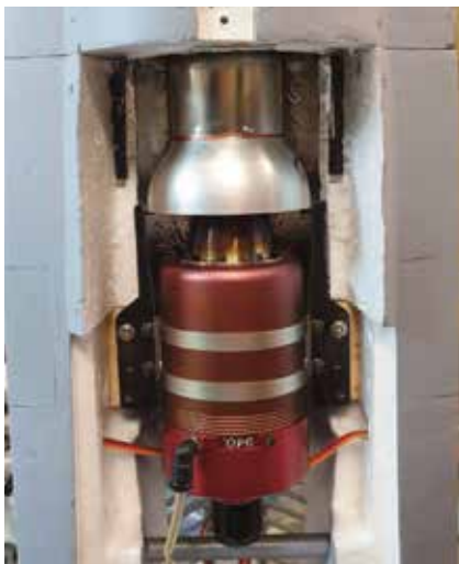
Turbine og afgangsrør monteret i modellen
