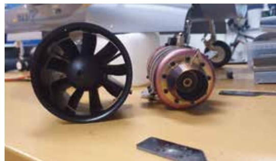
Sammenligning af tidligere el-fan og den nye jet turbine.
