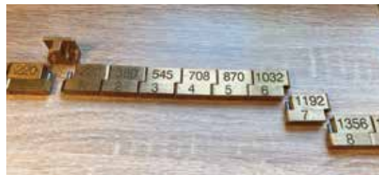
Modellerbart ballastsystem: Ballasten holdes stabilt sammen af en lille magnet som er limet i bunden af det hul som stiften går ind i når de kobles sammen. Når man vælger sin ballastmængde kobler man bare de yderste klodser som man ikke vil have i flyet fra, og putter resten ind i vingen. Til sidst "låses" ballasten med en klods i midten som har 2 spor som holder ballasten i midten af flyet, da denne klods er tykkere end ballastrøret og ballasten kan derfor ikke rutsje ud i den ene vinge.
