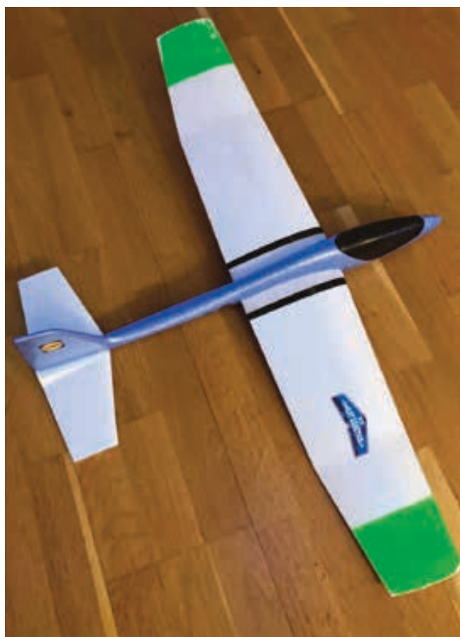
Den færdige model. Bemærk at midterstykket lægger lidt spændvidde til modellen, da vingen er skåret over på midten og sat ind i de 3D printede dele
