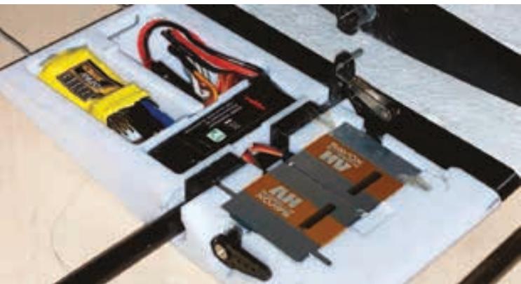
Nærbillede af den centrale del af vingevidnings systemet. Bemærk at alle det til RC ombygning er placeret i enheden
