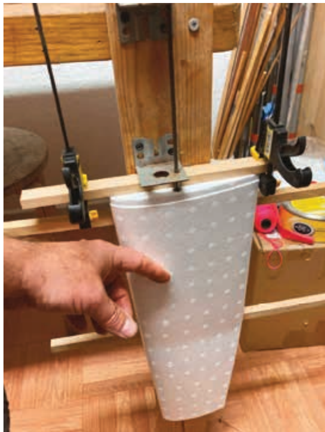
Hullet til den gennemgående hovedbjælke/vridakse smeltes ned i vingen med en varm pionotråd. Som hovedbjælke kan anvendes en kulstang, der kan erstattes af en pianotråd hvis der skal lidt ballast i.
