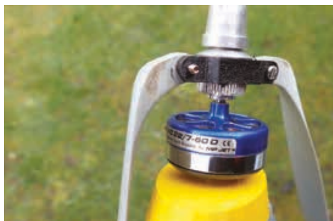
Den frontmonterede motor bruger 2,7 A. Både "brandskot" og propelmlemstykket til 6x5 propellen er 3D printede
