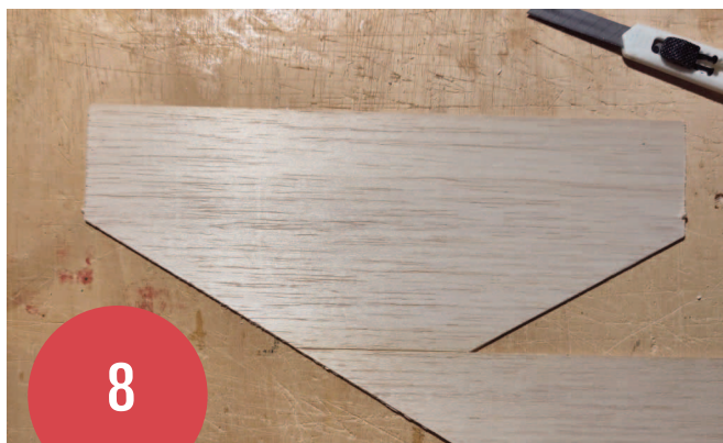
Når du skal skære vingen ud, skal det gøres ad 2 gange, da den er bredere end balsaet. Læg mærke til årenes retning på tegningen. Det er bølgestregerne. Se billede 6-11
