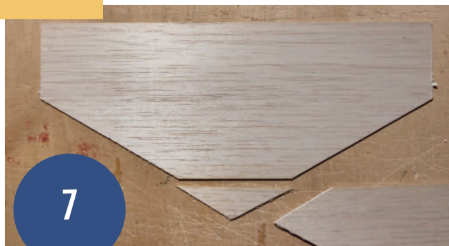
Når delene er skåret ud, er de ret kantede, så du kan pudse hjørnerne, så de bliver pænt runde.
