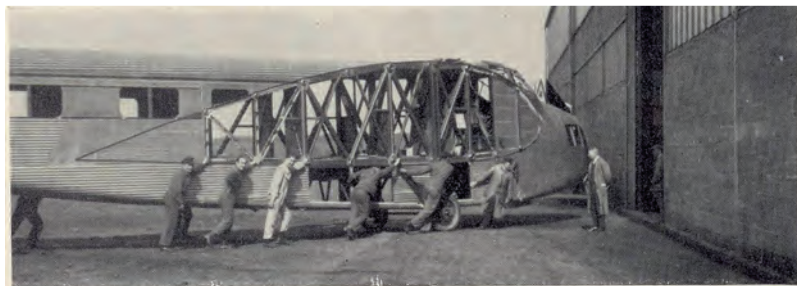
Kroppen til „Den flyvende Vinge“, Junkers G. 38, er helt af Metal. Typisk Planprofil for et stort, fritbærende Bæreplan.
