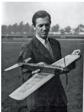
Peter Christiansen fra Helsingør satte 16. oktober 1949 danmarksk rekord med denne kunstflyvningsmodel i klasse F2. Hastigheden var 87 km/t og modellen var udstyret med en ny engelsk dieselmotor Amco på 3,5 kubikcentimeter.
